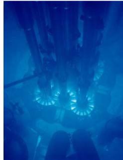
Foto do tanque de arrefecimento do Reator de Testes Avançados (Idaho National Laboratory) mostrando radiação de Čerenkov
